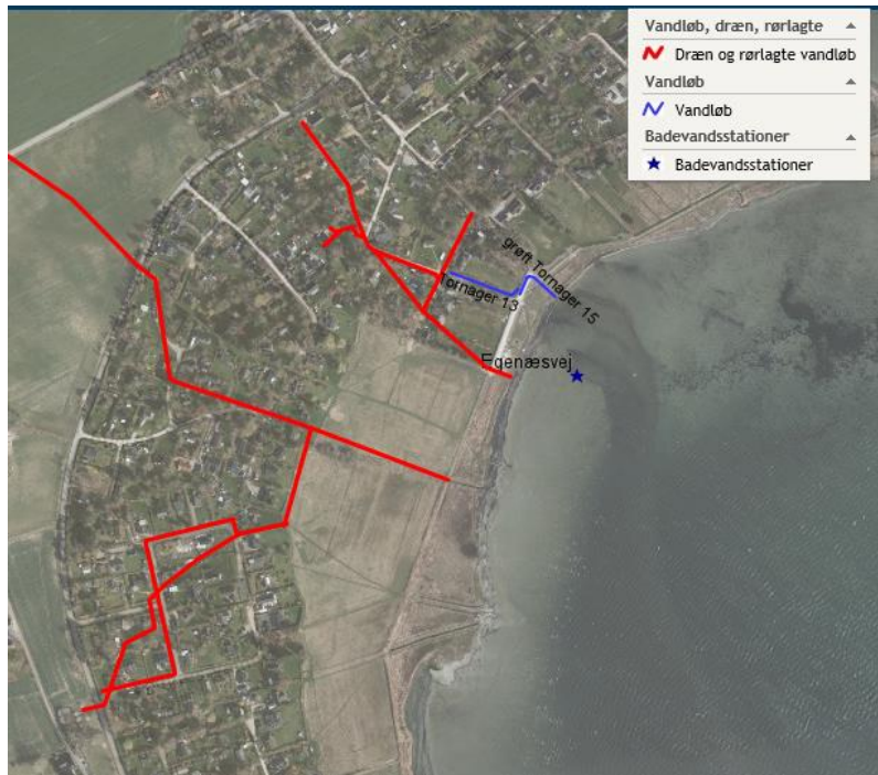
Fig. 3. Oversigtskort over de registrerede udløb i nærheden af badestedet
