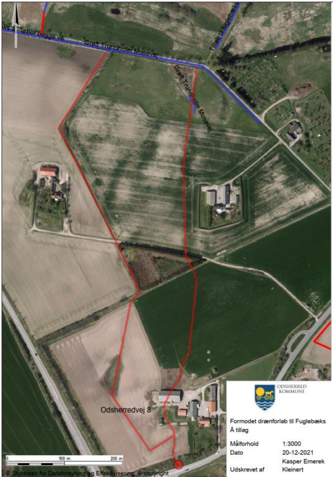
Figur 1.2: Formodet drænførløb gennem Odsherredvej 8/Odsherredvej 8a og ned til Trundholm Mosevej grøft er vist med rød streg. Grøften er vist med blå streg. Kilde: Indeholder data fra Styrelsen for Dataforsyning og Effektivisering; Ortofoto forår 2024, matrikler, januar 2025
