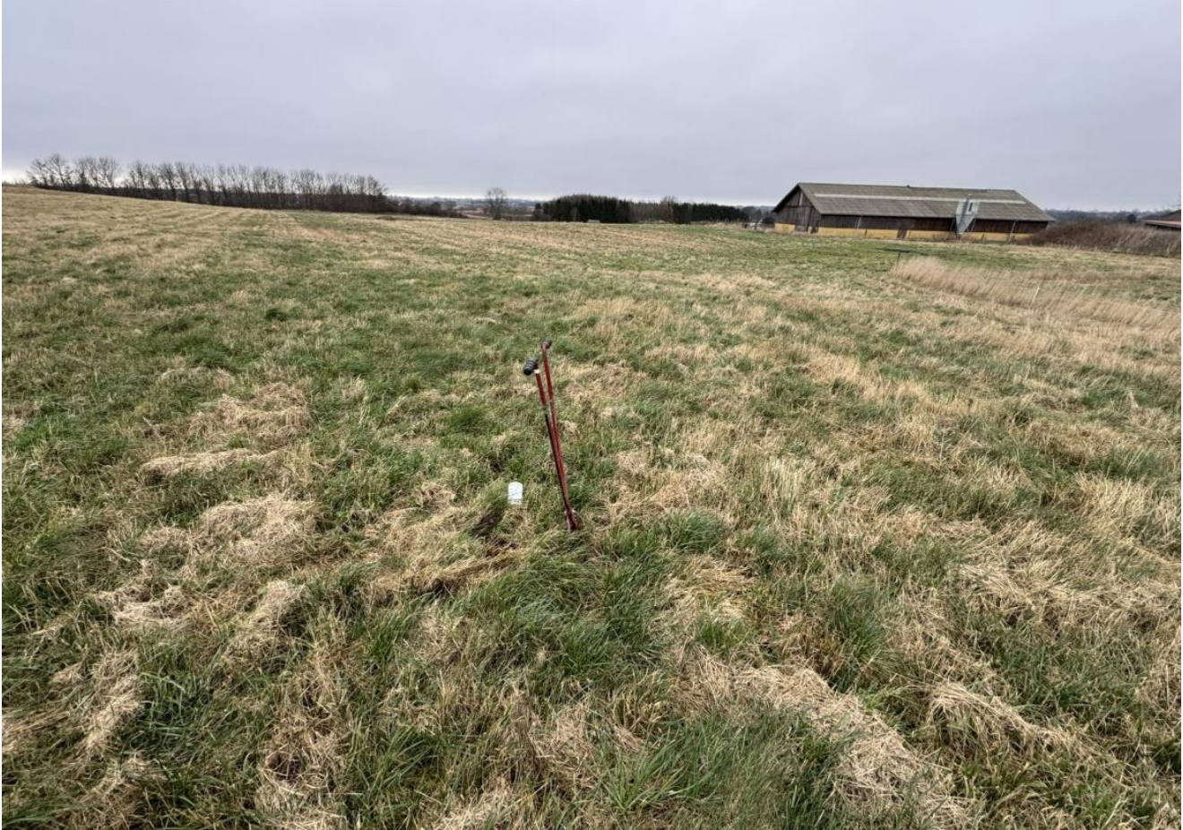
Figur 2.1: Udtagning af overfladeprøver blev udført med håndbor
